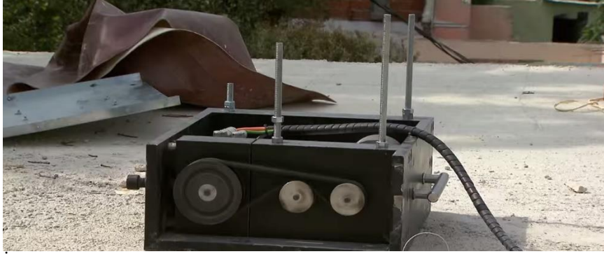
Şekil 2. İTÜ İnşaat Mühendisliği Bölümü’nün 2014 yılında gerçekleştirdiği Mevcut Binalarda Tam Ölçekli Deneylerle Deprem Performansının Saptanması Projesinde kullanılan TESTBOX™-SHAKER Sarsıcısı
